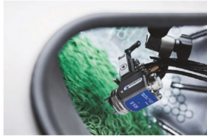
Bild 2: Sprühpistolen verteilen das Beschichtungsmaterial homogen auf der Oberfläche der Elastomerteile (Bild: Walther Trowal GmbH)
