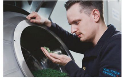
Bild 3: Die Teile verlassen die Trommel trocken und können sofort weiterverarbeitet werden (Bild: Walther Trowal GmbH)
