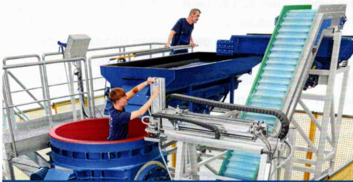
Der Arbeitsbehälter des neuen Multivibrators MV 50 für große Werkstücke hat einen Innendurchmesser von 1.600 mm.
