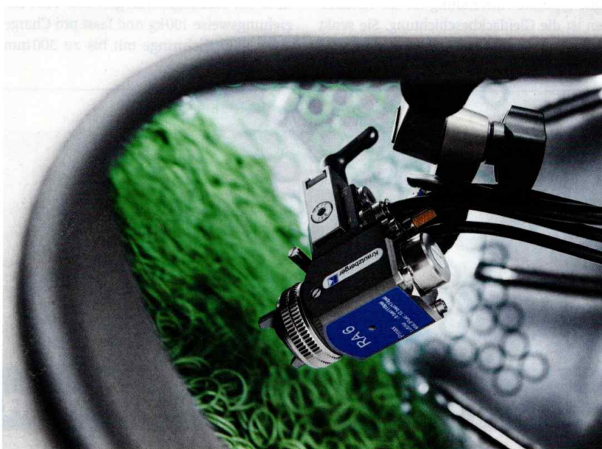
Mit neuer Sensorik und einem elektropneumatischen Ventil regelt die Maschine den Volumenstrom der Sprühmedien präzise.
