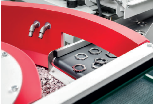
Bild 3: Die Werkstücke werden über ein Förderband von der Seite zugeführt
