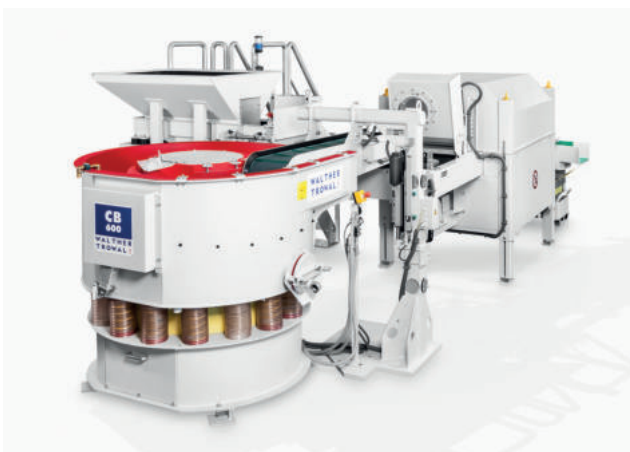
Bild 2a: Ein CB-Rundvibrator mit einem Magnetseparierer, der magnetische Werkstücke aus dem Schleifkörperbett entnimmt und sie einem Trockner (rechts im Bild) zuführt
