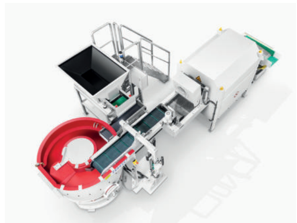
Bild 2b: Ein CB-Rundvibrator für die chargenweise Zugabe der Werkstücke über einen Eingabetrichter.
