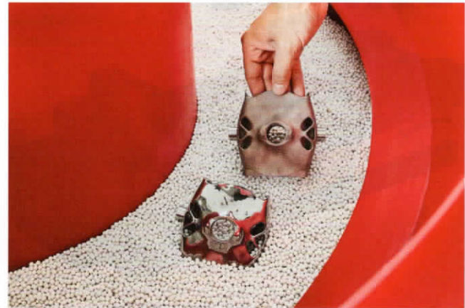
Bild 2: Ein additiv gefertigter Kardanrahmen vor (oben) und nach dem Trowalisieren
