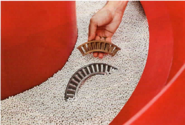
Bild 1: Ein additiv gefertigtes Blisk-Segment vor (oben) und nach dem Trowalisieren
