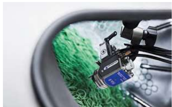
Bild 2: Mit neuer Sensorik und einem elektropneumatischen Ventil regelt man den Volumenstrom der Sprühmedien präzise
