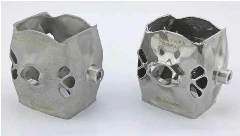
Ein additiv gefertigter Kardanrahmen vor (links) und nach dem Trowalisieren. Bilder: Walther Trowal
