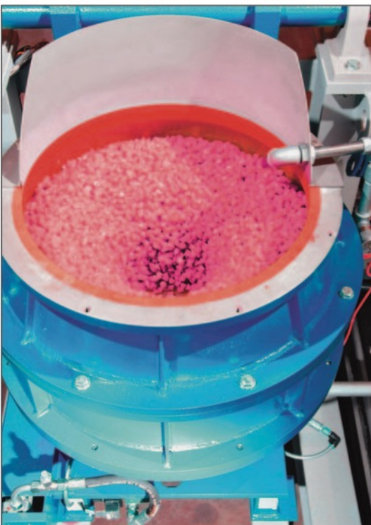
Beim Gleitschleifen unterliegt die Auskleidung des Arbeitsbehälters naturgemäss einem beträchtlichen Verschleiss. (Bilder: Walther Trowal)
