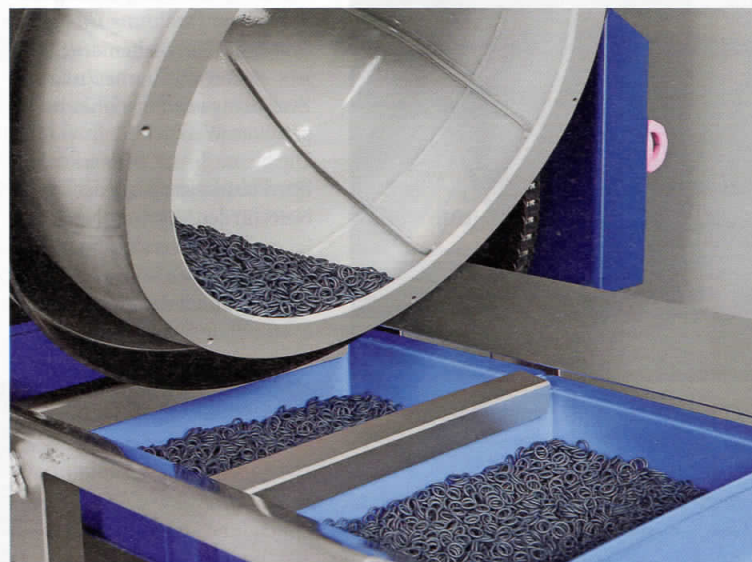
Zum Entleeren der beschichteten Ringe schwenkt ein Pneumatikzylinder die Trommel nach unten.
