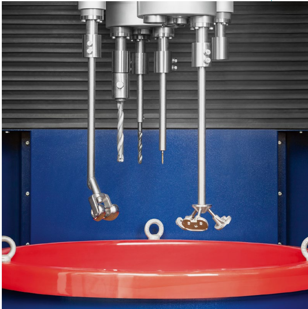
BILD 3 Die Satelliten der neuen Schleppschleifanlage nehmen bis zu 18 Teile auf, nur für dieses Foto wurden unterschiedliche Werkstücke eingespannt. (© Walther Trowal)
