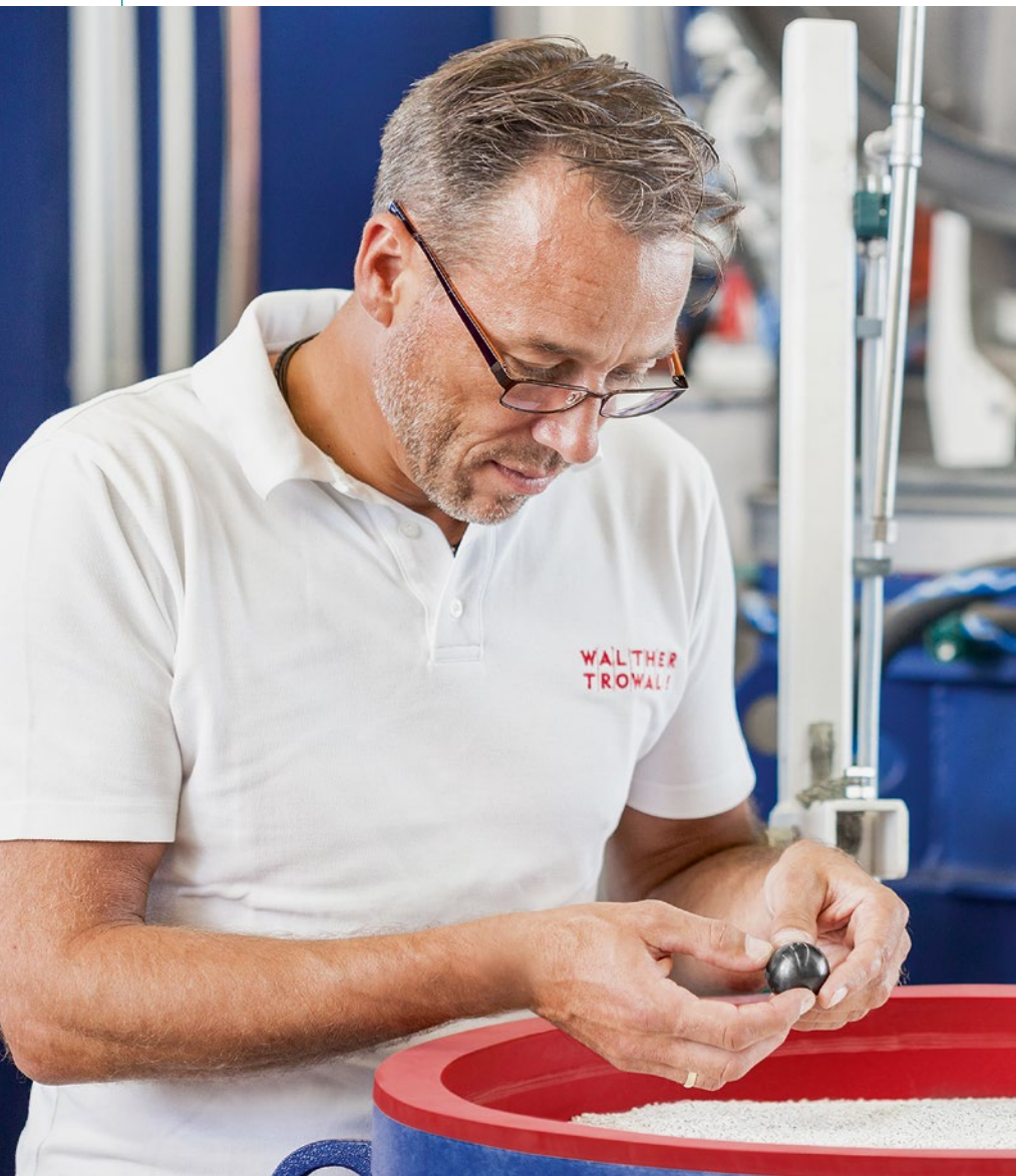
BILD 1 Obwohl die Keramiksicht extrem hart ist, entsteht aus der ursprünglich rauen Oberfläche eine glatte, hoch glänzende, die extrem verschleißfest ist. (© Walther Trowal)
