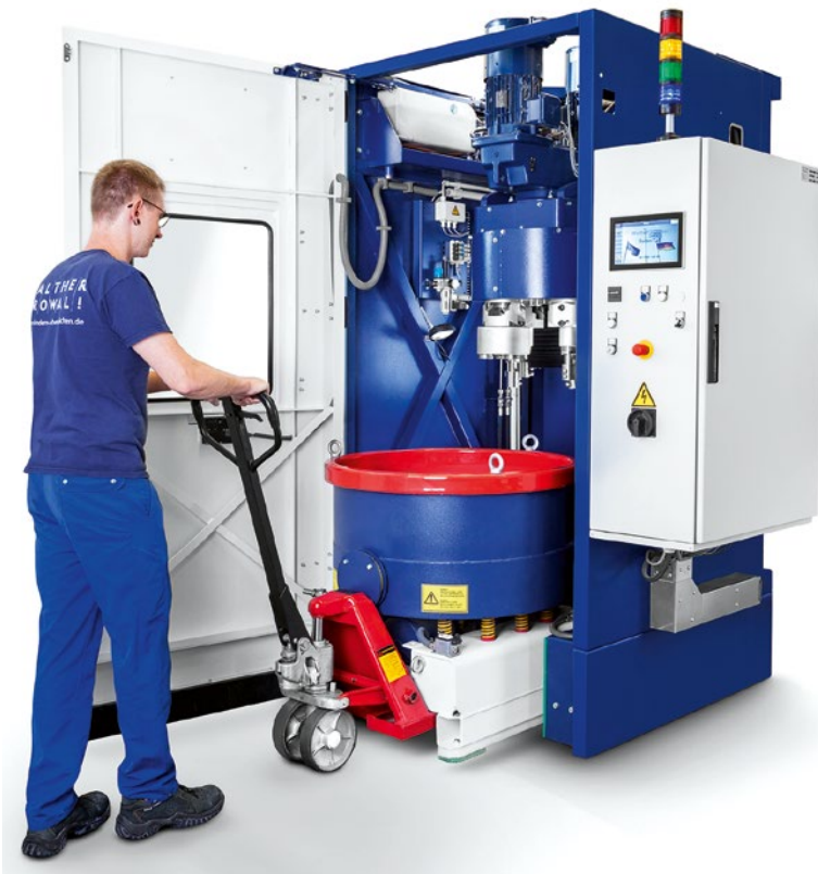
BILD 4 Alle Prozessschritte in derselben Maschine: Ein Arbeitsbehälter wird mit einem Handhubwagen aus der Maschine gezogen und innerhalb kürzester Zeit durch einen ersetzt, der andere Schleifkörper enthält. (© Walther Trowal)
